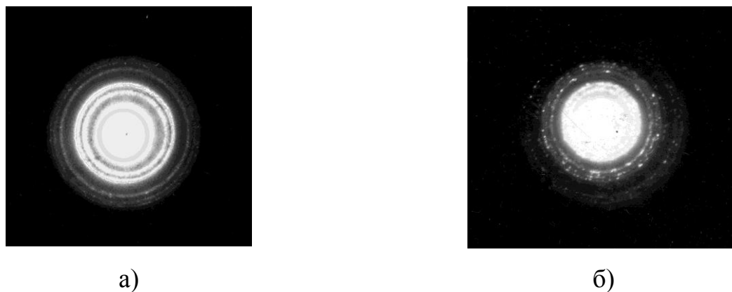
Рис. 3.1. Электронограммы фуллеритовых плёнок, сконденсированных на свежий (а) и полированный (б) сколы NaCl
