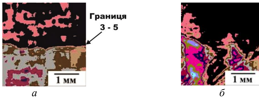
Рис.9. КОК приграничних ділянок двох зерен 3 та 5 двовимірного полікристалічного зразка алюмінію після візуалізації на них ефекту "розсіпання" границі: а – \varepsilon = 0\% ; б – \varepsilon = 27\% .
