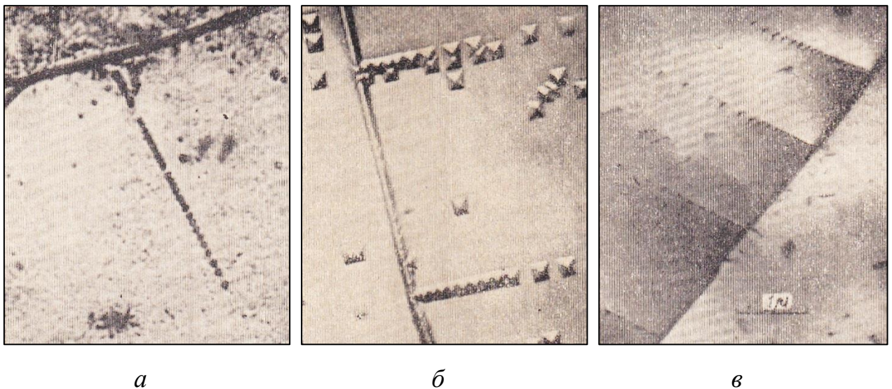
Рис. 1.16. Результати експериментального спостереження дислокаційного скупчення у границь зерен в зразках: \alpha -латуні ( a ), LiF ( б ), нержавіючої сталі ( в ) [51-53].
