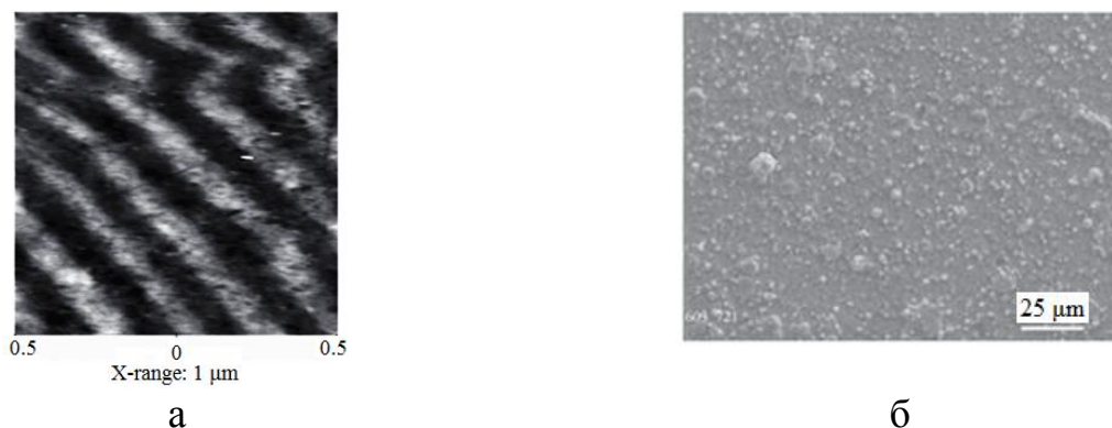
Рис. 1.17 SEM-знімок перерізу вакуумно-дугового покриття TiN/ZrN : а – поперечний знімок; б – вид зверху (морфологія) [73]
