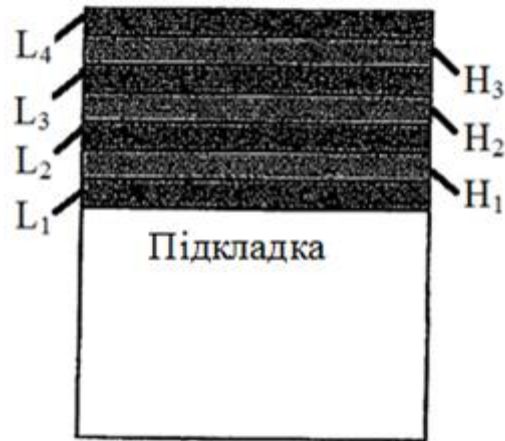
Рис. 1.3 Багатошарове покриття нітриду титану на титановій підкладці при зміні амплітуди зміщення в процесі осадження [31]
