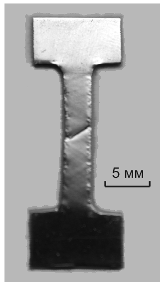
Рис.3 Изображение поверхности образца сплаве Al-3%Mg ( T = 300 К, \varepsilon = 20 %) с характерными линейными участками локализации деформации.
