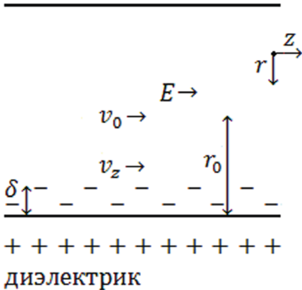
Рис.1. Схема, иллюстрирующая движение жидкости в единичном капилляре под действием электрического поля E.
