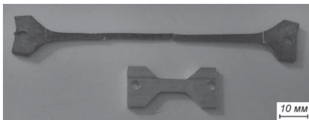
Рис.5. Общий вид образца сплава 01420Т, сверхпластично продеформированного до разрушения при T = 520^{\circ}\text{C} и напряжении течения \sigma = 5,5 МПа, в сравнении с исходным образцом.
